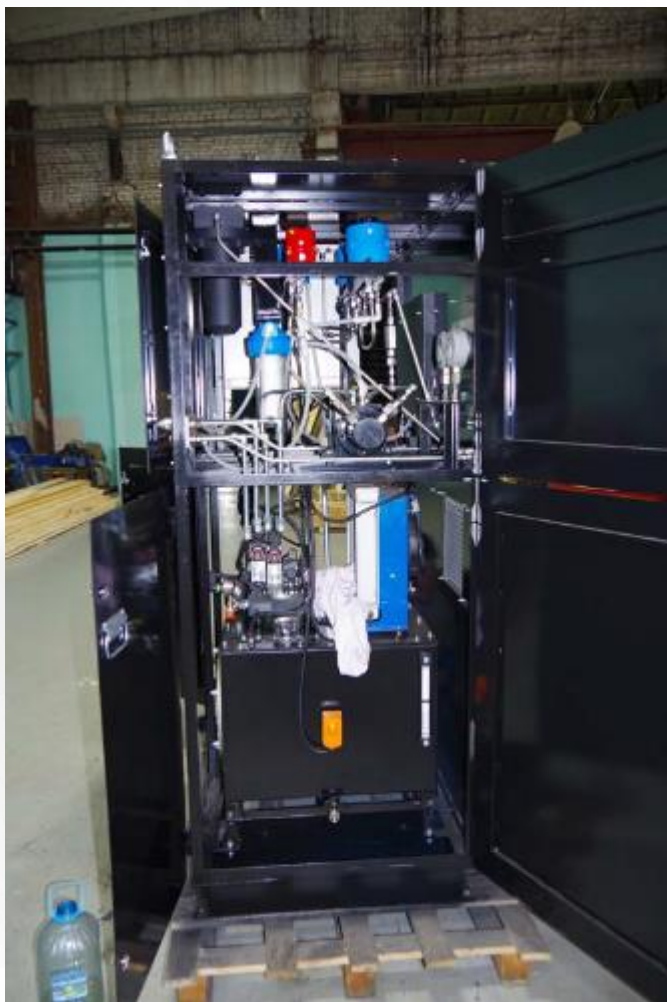
Мультипликатор «масло-вода» Давление 500 кгс/см 2
